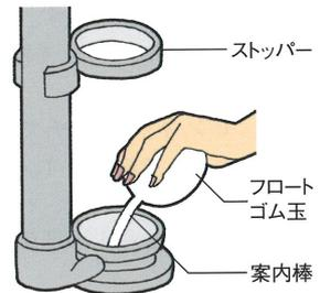
04 新しいフロートゴムの案内棒をガイド穴に差し込みます。フロートゴムに付いているクサリをストッパーの中を通し、洗浄ハンドル先端のフックに、クサリの玉が3～4個たるむように引っ掛けます。
