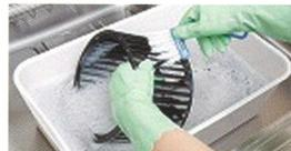
洗い桶等に浸け置きして洗い、よく乾かしてから取り外したのと逆の手順で元に戻します。
