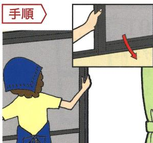
**01** まず上のレールに網戸を差し込みます。網戸を持ち上げながら、下を室内側へ引き寄せ、戸車をレールの上にのせます。
