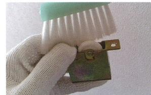
**05** レールに付着したホコリはシリコンスプレーを吹き付け乾いた布で拭き取ると落ち、滑りも良くなります。
