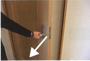
現在の住宅は昔と比べて気密性が高いため、ドアを急激に開閉した時に廊下側に空気圧がかかり、空気が押されたり引っ張られたりします。その時に固定されているものは動きませんが、引戸類は固定されていないためにその圧によりがたつくと考えられます。開閉時はゆっくり開閉させましょう。
